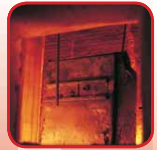
Armoire en cours d'essai après 30 minutes de chauffe. Température du four \pm 930°C
