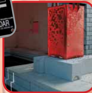
Armoire sortant du four avant impact.
