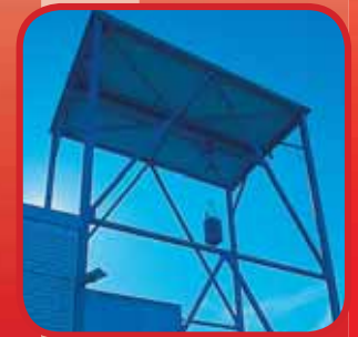
Armoire sur portique avant chute de 9,15 m simulant l'effondrement de 3 étages.
